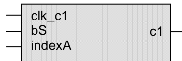
Figura 21 – Sinais de entrada (esquerda) e saída (direita) do módulo calculador de c_1
